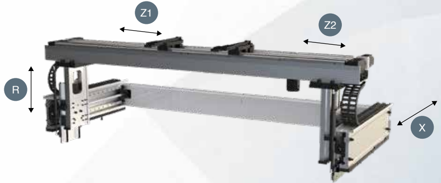
CNC Opsiyonel Arka Dayama X - R X - R - Z1, Z2 X - R - Z1, Z2, Delta X
